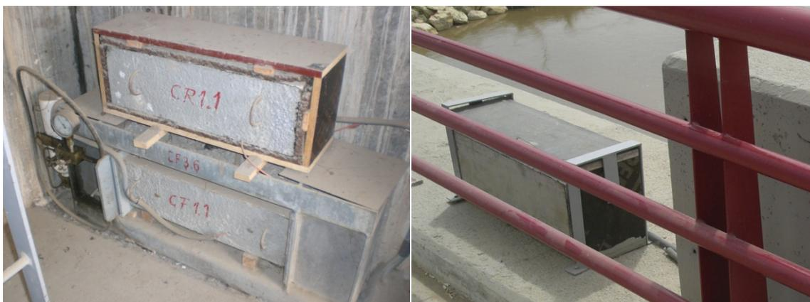
Figura 3. Provetes de retração e provete de fluência na ponte 4 de Abril
