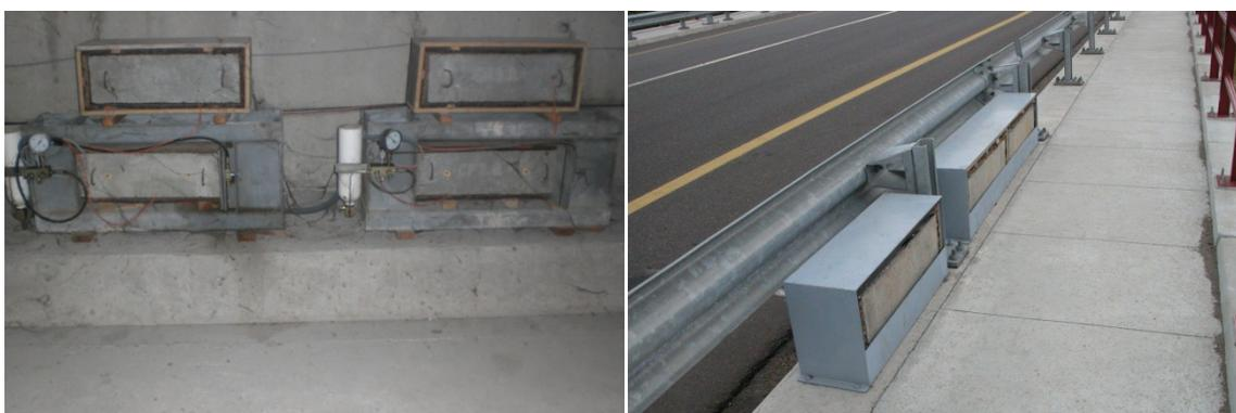
Figura 4. Provetes termo-higrométricos e de fluência na Ponte 17 de Setembro
