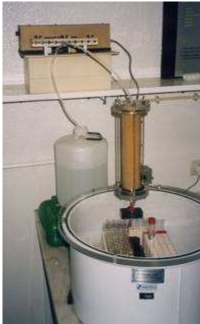
Fig. 57 - Equipamento de ensaio em coluna do NAS para determinação de parâmetros de meios porosos
