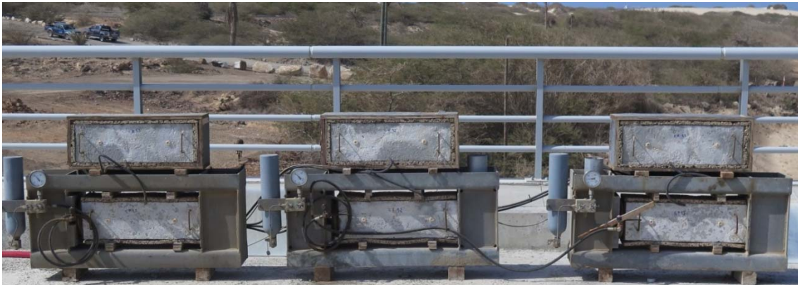
Figura 3. Provetes para a caracterização in situ da retração e da fluência do betão.
