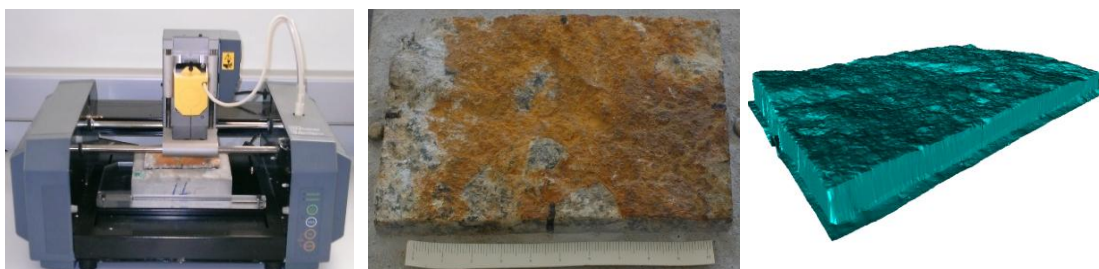
Figura 1 - Digitalização: a) Scanner; b) Exemplo de um provete analisado; c) Imagem digital do provete
