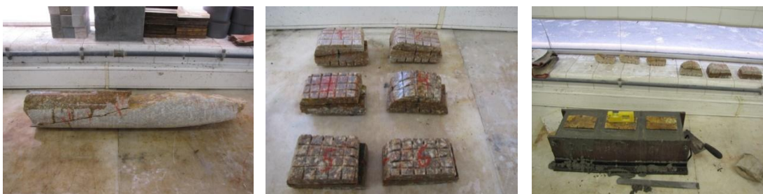
Figura 2 - Preparação das diaclases: a) amostras; b) amostras após corte; encabeçamento de um provete
