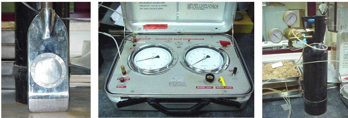
Figura 5 – Ensaio DMT: a) Lâmina de ensaio; b) Consola de leitura; c) Garrafa de gás pressurizado.
