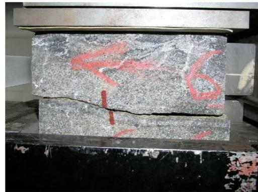
Figura 3. Ensaio de deslizamento de diaclases
