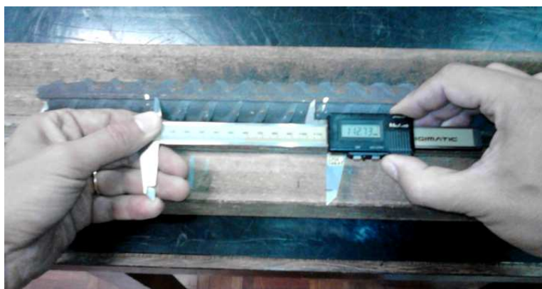
Figura 3. Exemplo da medição do comprimento final entre referências ( L'_u ) após a rotura do provete.
