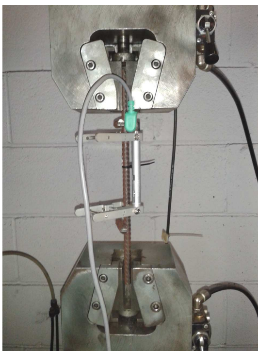
Figura 2. Colocação de um extensómetro no varão para determinação da extensão total na força máxima, através do ensaio de tracção.
