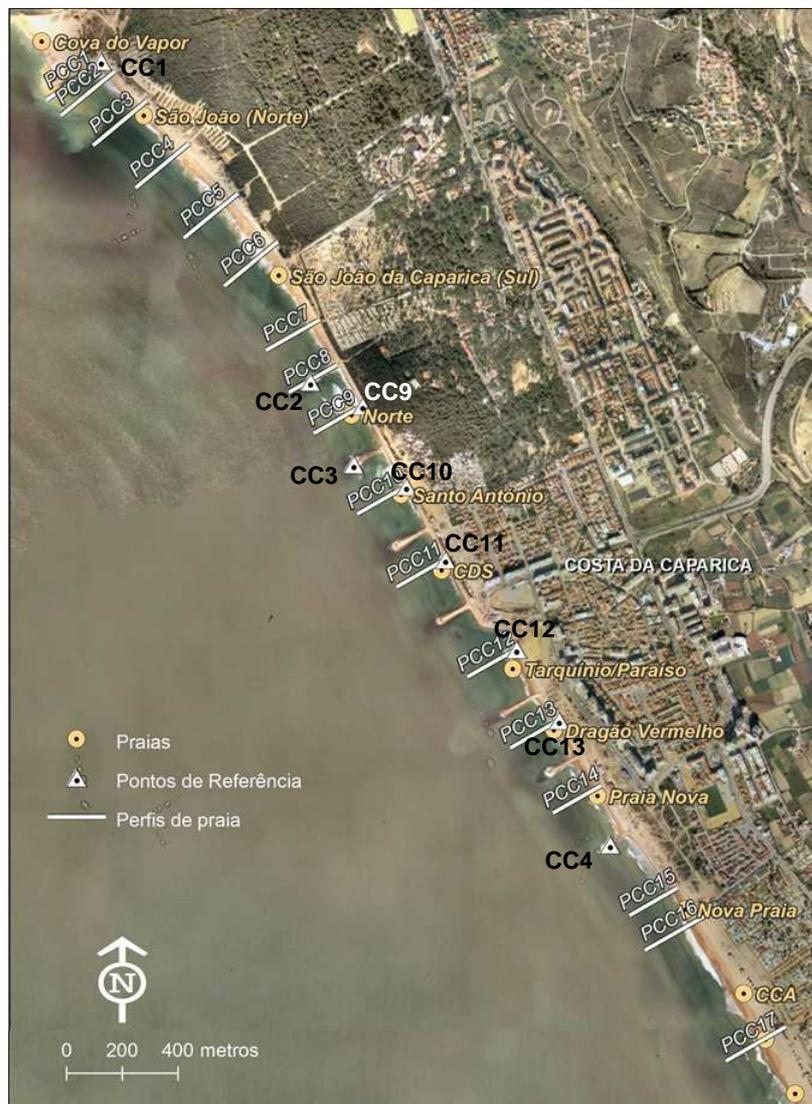
Figura 6: Perfis que serão levantados e pontos de referência.
