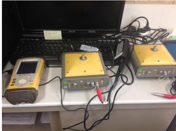
**Figura 18: Receptores GPS (BASE e ROVER) e controlador**
