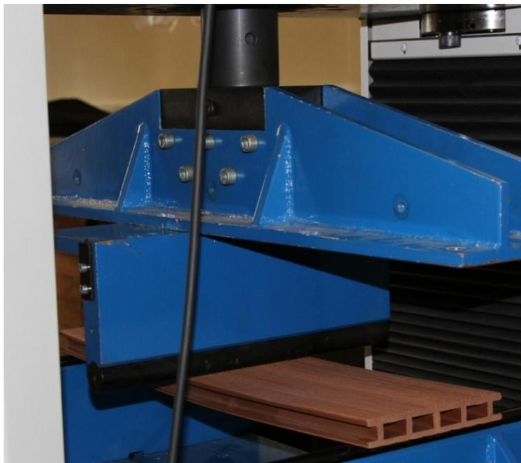
Figura 2. Ensaio de flexão.
