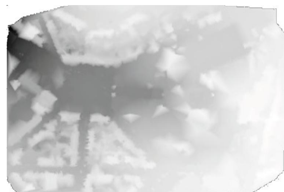
Figura 4 – MDS obtido no pré-processamento, antes da densificação.
