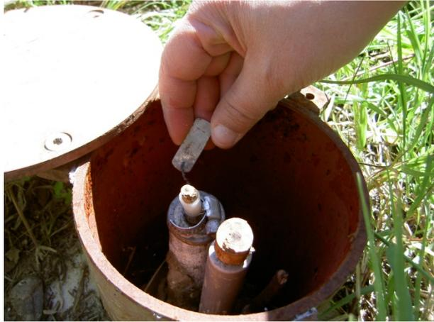
Figura 2.2 – Piezómetros PZ1, PZ2 e PZ3, LNEC (a N do PHM) (Lobo-Ferreira *et al.*, 2012)
