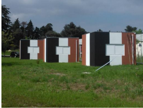
Figura 1. Células experimentais à escala real pintadas com três tintas refletantes.
