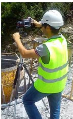
Figura 4.5 – Câmera montada num tripé para obtenção de imagens no terceiro levantamento.
