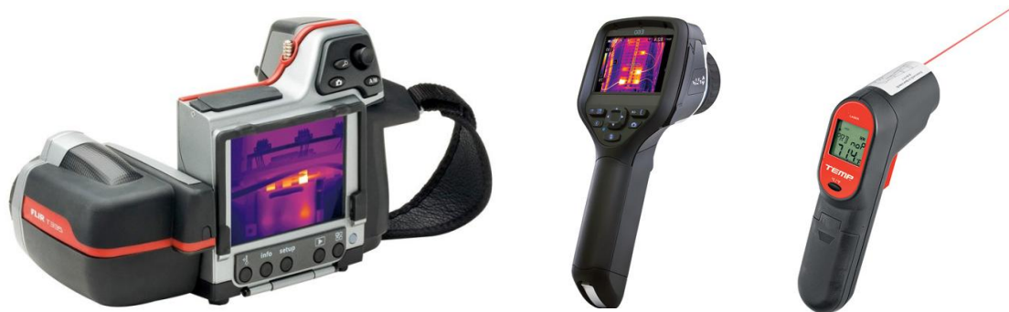
Figura 2.1 – Três modelos de equipamentos para medição de temperatura por infravermelhos: duas câmaras termográficas e um termómetro pontual.
