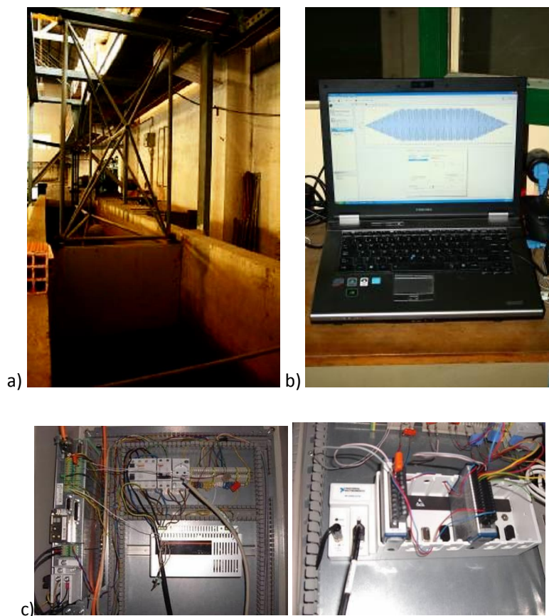
Figura 8 – Sistema de geração das ondas: a) Batedor de ondas; b) Computador de geração do sinal (CPU1); c) Painel de atuação do gerador.
