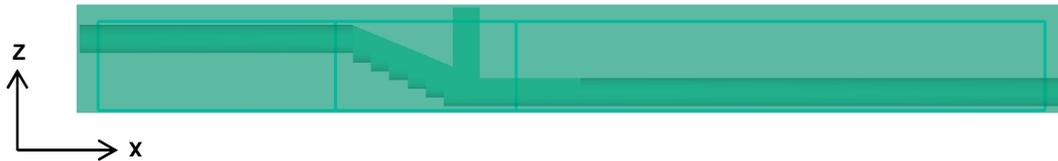
Figura 3. Geometría correspondiente a la caída con solera en escalones
