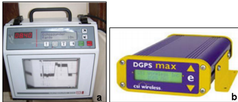
Figura 5. a) Imagem do Ecobatímetro Navisound 205, b) Imagem do DGPS Max – CSI Wireless
