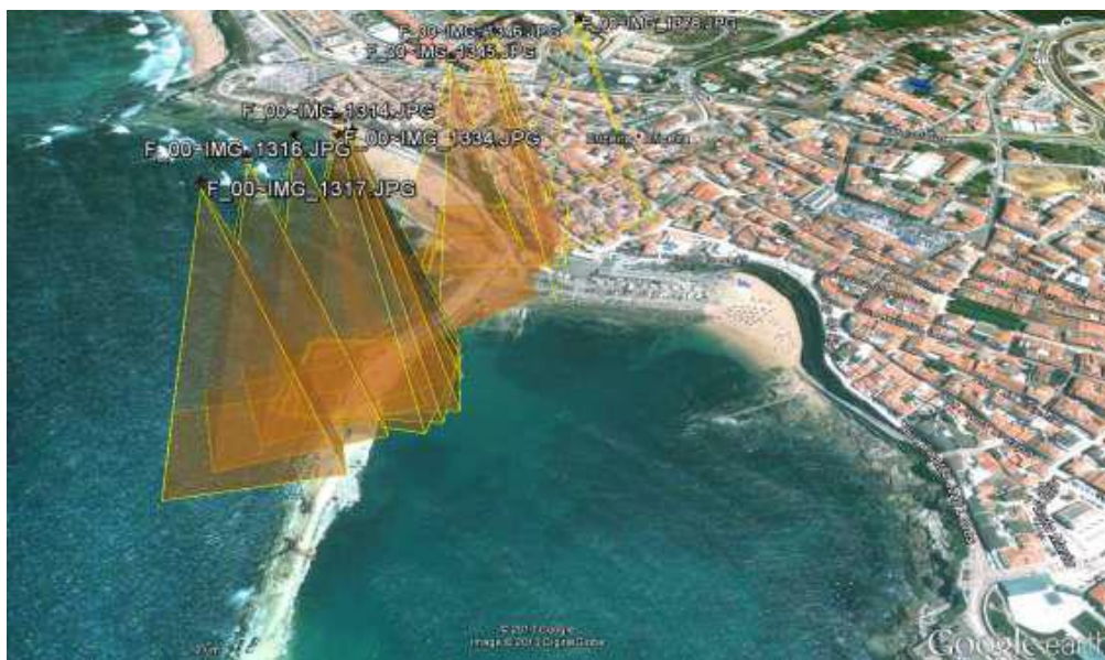
Figura 3.1 – Prismas de aquisição das quinze fotografias disponíveis
