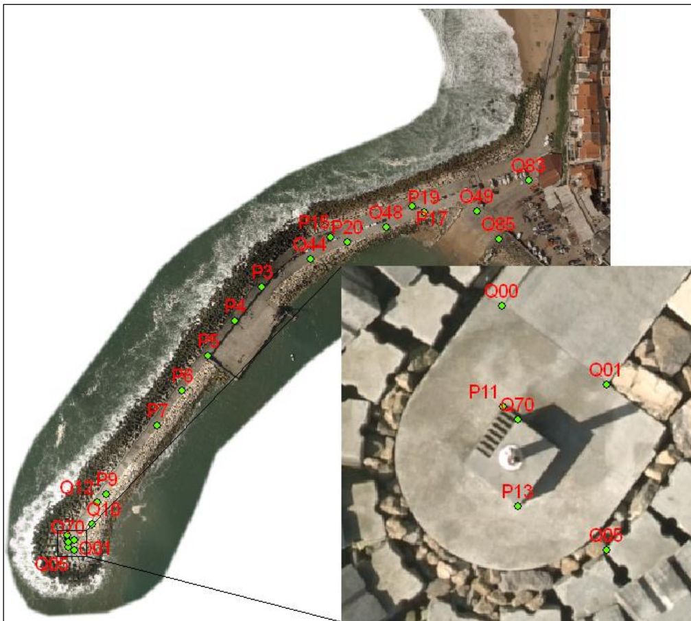
Figura 3.8 – Localização dos pontos de controlo no quebra-mar
