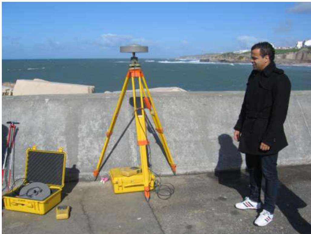
Figura 2.6 – Estação de referência GNSS
