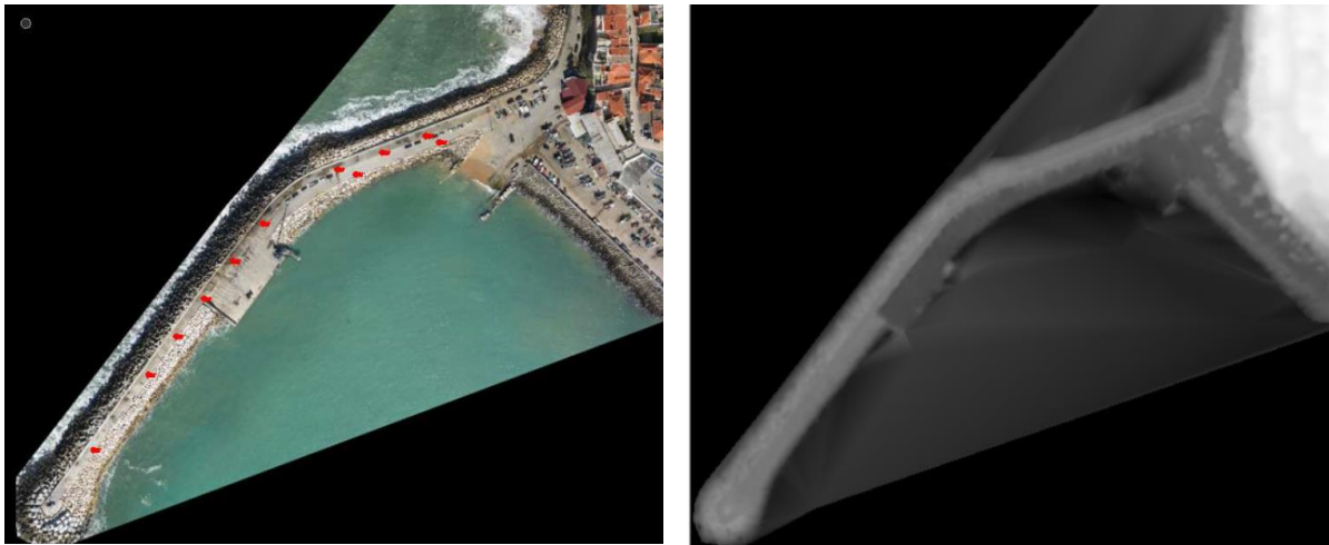
Figura 3.2 – Mosaico ortorretificado do quebra-mar com os pontos de controlo sinalizados a vermelho e respetivo MNS
