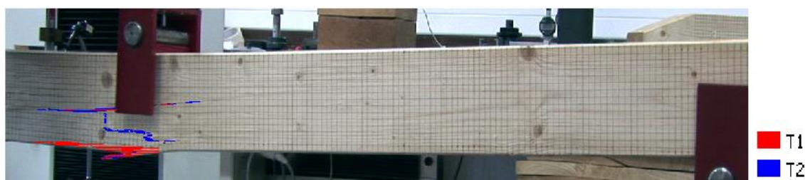
Figura 3.4 – Evolução da fratura ao longo do ensaio, em que T1 é o instante correspondente à primeira imagem e T2 o correspondente à segunda (câmara do lado direito)
