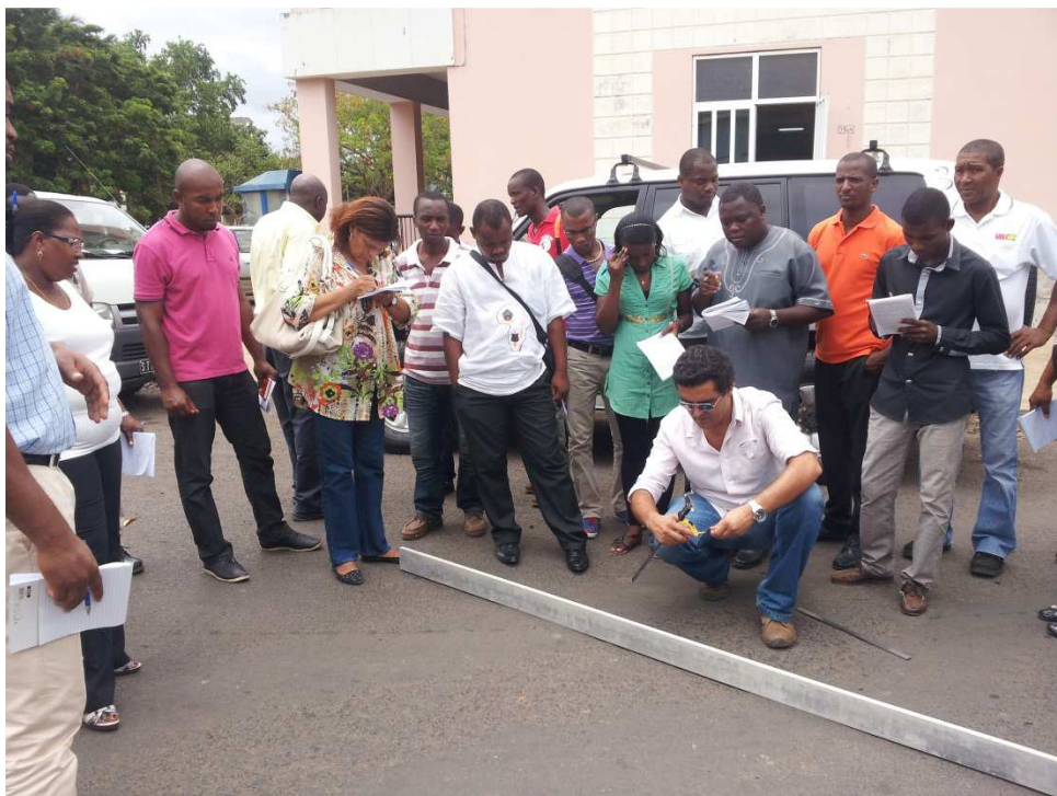
Figura 2.2 – Medição de cavados de rodeira
