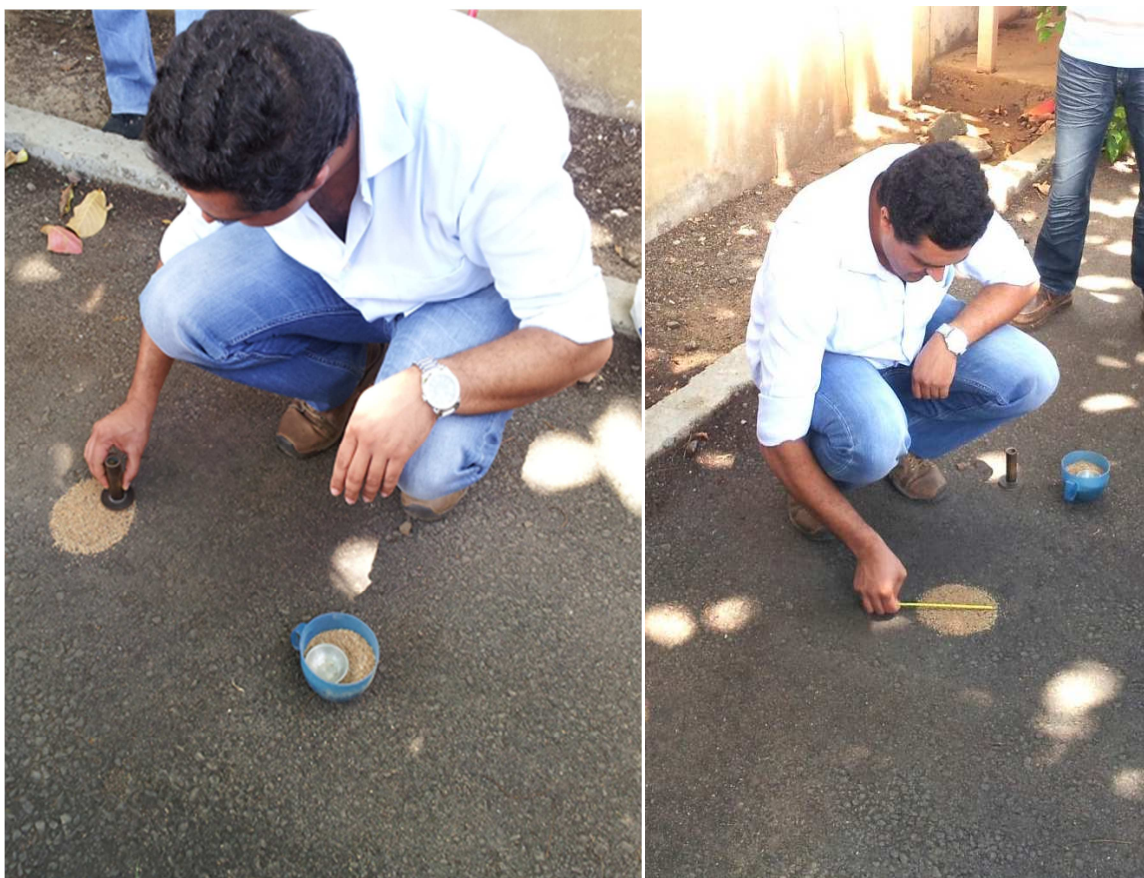
Figura 2.5 – Realização do ensaio da mancha de areia para avaliação da profundidade de textura
