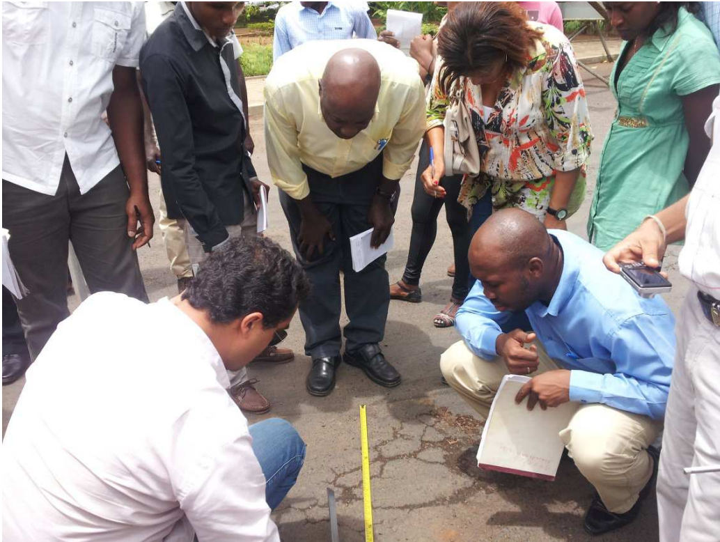
Figura 2.3 – Avaliação de fendilhamento “pele de crocodilo”, da sua área e do nível de gravidade
