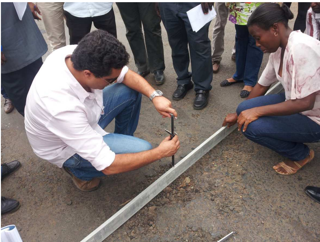
Figura 2.4 – Utilização do paquímetro na medição da profundidade de ninhos
