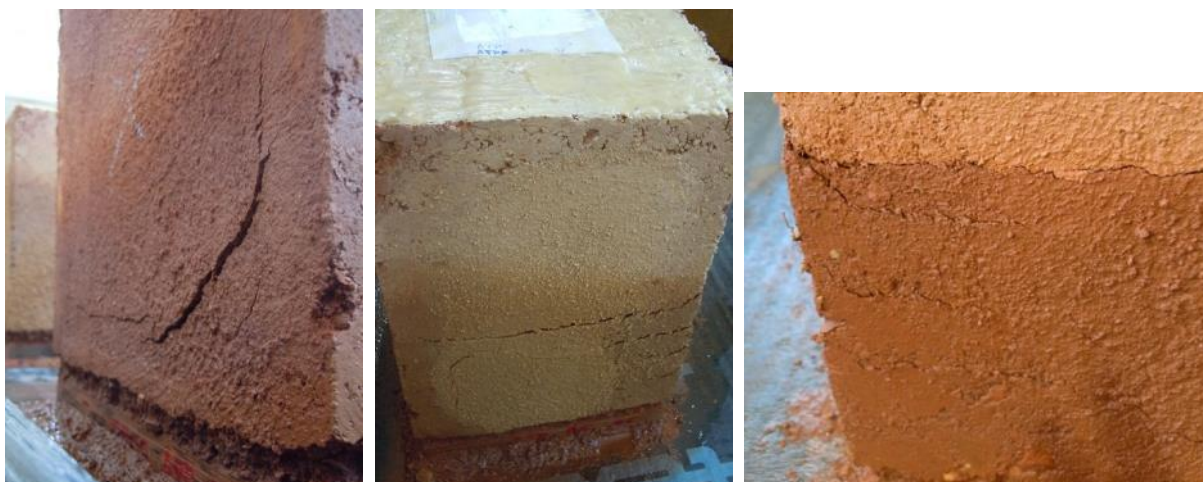
Figura 7.33. Bloco BPD após terminada a fase de absorção de água por ascensão capilar: à esquerda, destacamento da argamassa APD; ao centro, fissuras horizontais na taipa na interface entre as camadas de compactação que se propagam pela interface com a argamassa de reparação ATP; à direita, fissuras horizontais na interface entre as camadas de compactação da taipa que se propagam pela zona da reparação da anomalia superficial com a argamassa APD
