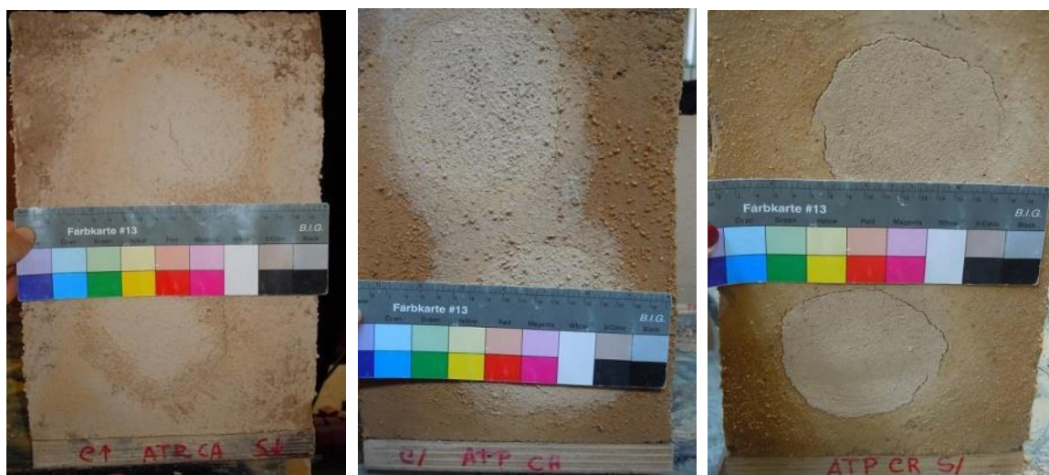
Figura 7.14. Anomalias: à esquerda, fendas médias na argamassa ATP_CA15 aplicada no bloco BVC; ao centro, fendas médias na argamassa ATP_CH15 na zona de interface entre a argamassa e o bloco BAV; à direita, fendas médias na argamassa ATP_CN15 na zona de interface entre a argamassa e o bloco BAV
