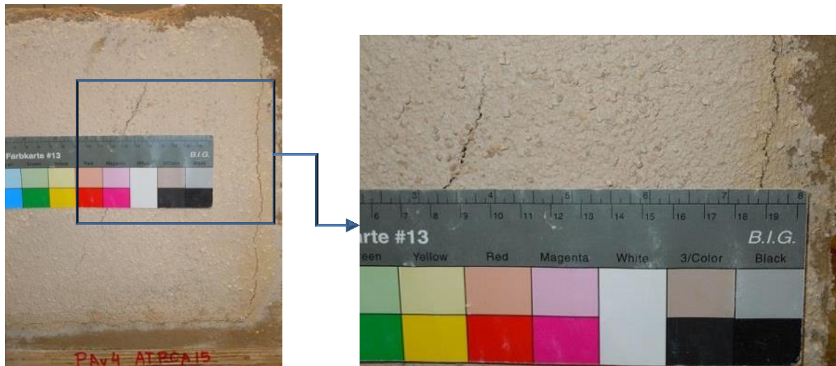
Figura 7.9. Argamassa ATP_CA15 aplicada no bloco BAv com o pormenor de uma fenda média, aos 10 dias de idade
