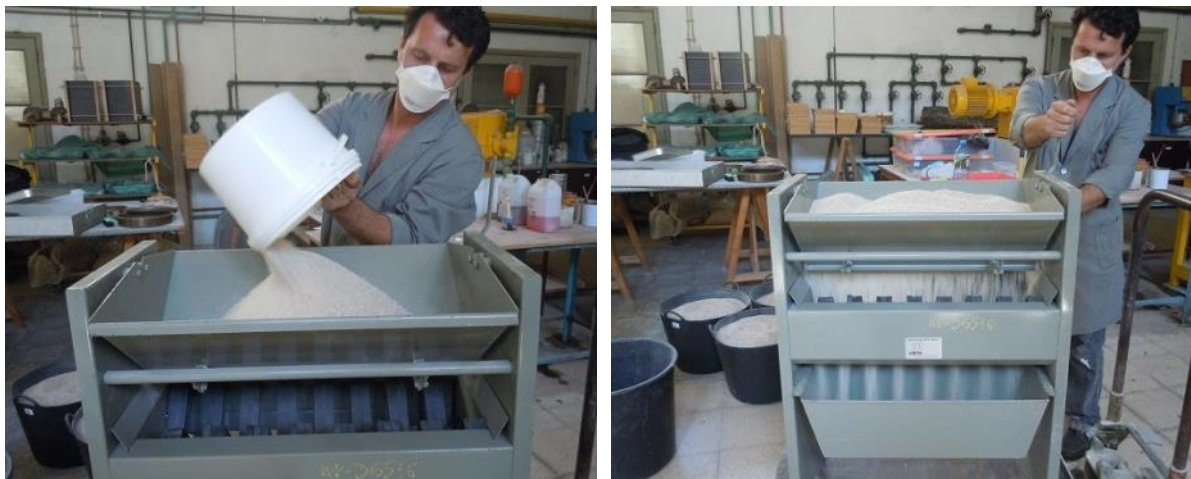
Figura 5.6. Homogeneização da areia com o auxílio de um repartidor
