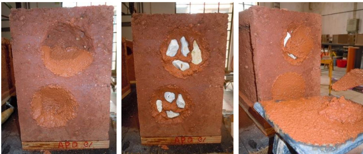
Figura 7.3. Aplicação da argamassa APD no defeito-padrão profundo com a utilização de encasque no bloco BPD
