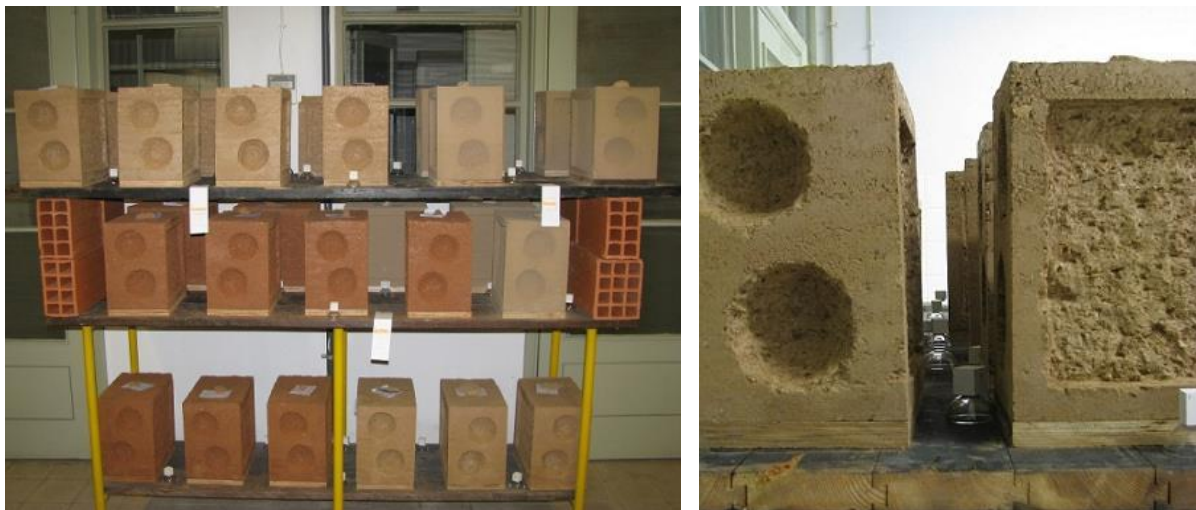
Figura 5.11. Disposição dos blocos de taipa na sala condicionada
