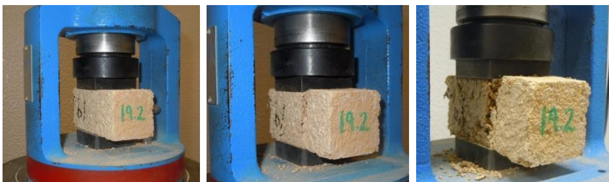
Figura 3.9. Provede sujeito ao ensaio de resistência à compressão
