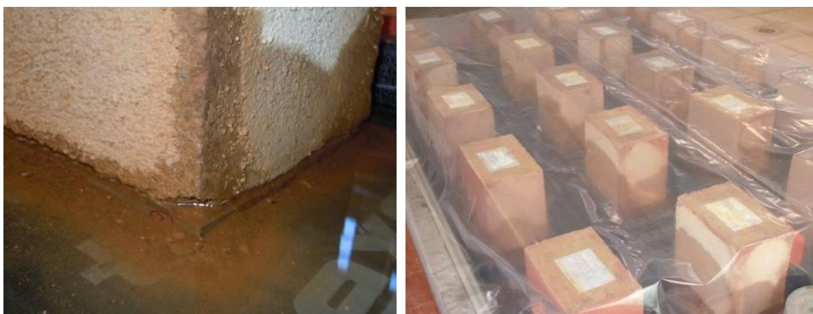
Figura 7.25. À esquerda, degradação na base do bloco, devido à agressividade do método de absorção de água por ascensão capilar, e à direita, blocos cobertos com um plástico para criar um ambiente de elevada humidade relativa
