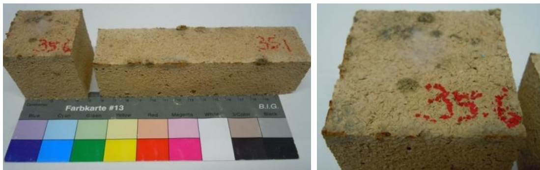
Figura 6.21. Fungos nos provetes ATP_CN5_Fib, aos 90 dias de cura
