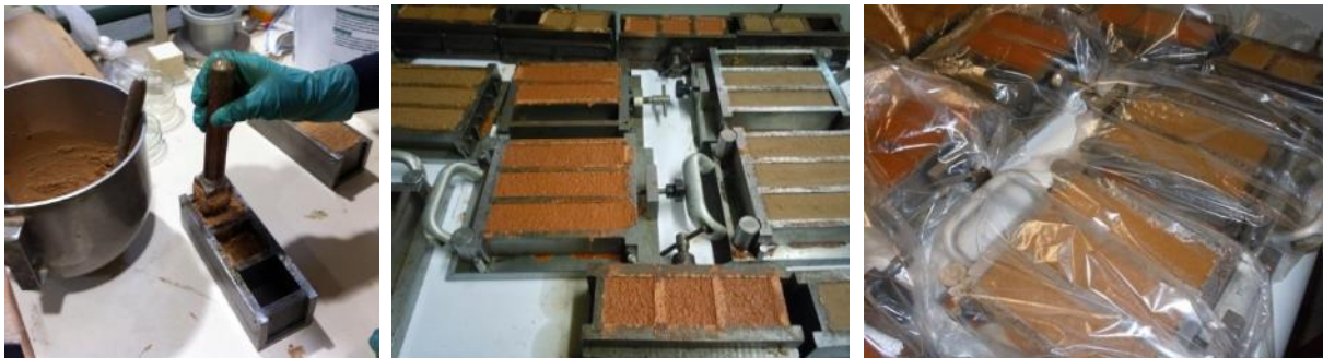
Figura 6.19. Sequência de trabalhos para a realização dos provetes cúbicos e prismáticos
