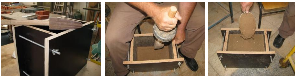
Figura 5.8. Execução dos blocos de taipa: à esquerda, molde e maço; ao centro, execução do provete através de compactação com o auxílio do maço; à direita, preenchimento do molde com a última camada de terra
