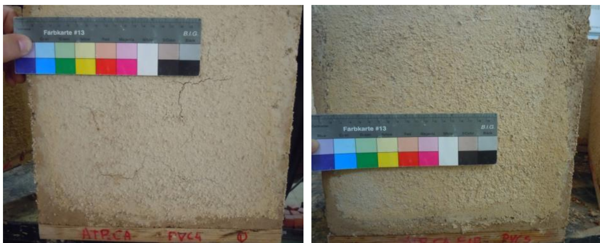
Figura 7.11. Argamassa ATP_CA15 aplicada no bloco BVC: à esquerda, sem fibras; à direita, com fibras
