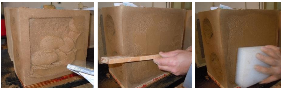
Figura 7.2. Aplicação da argamassa AAv no defeito-padrão superficial do bloco BAv
