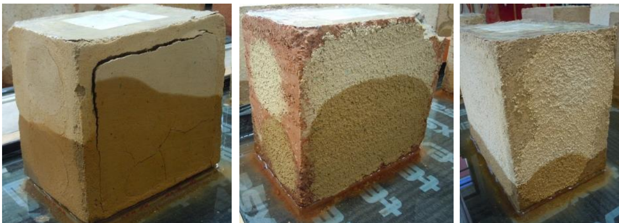
Figura 7.29. Método de absorção de água por ascensão capilar, ao fim de 12 h em absorção capilar: à esquerda, BAv com argamassa ATP_CN; ao centro, BPD com a argamassa ATP_CP; à direita, BVC com a argamassa ATP_CH
