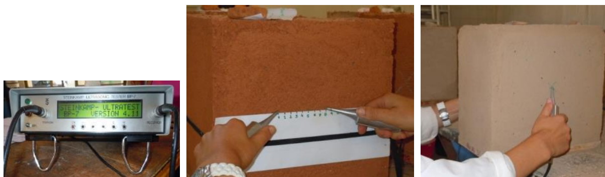
Figura 3.12. Ensaio de ultrassons: à esquerda, aparelho de ultrassons modelo Steinkamp ultrasonic tester BP-7 version 4.11; ao centro, método de transmissão indireta; à direita, método de transmissão direta
