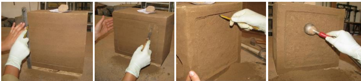
Figura 5.9. Sequência dos trabalhos para a realização do defeito-padrão superficial no bloco de Avis
