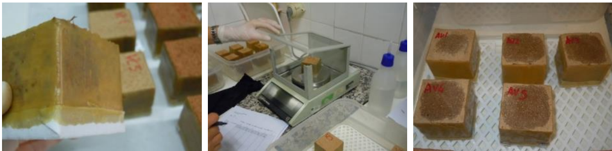
Figura 3.5. Sequência dos trabalhos no ensaio de absorção de água por capilaridade: à esquerda, provete impermeabilizado com pez de louro e cera de abelha, com a face inferior coberta com tecido de algodão; ao centro, pesagem do provete; à direita, provetes sujeitos à absorção de água por capilaridade, com a franja capilar já a chegar ao topo
