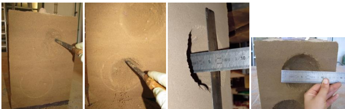
Figura 5.10. Sequência dos trabalhos para a realização do defeito-padrão profundo no bloco de Avis
