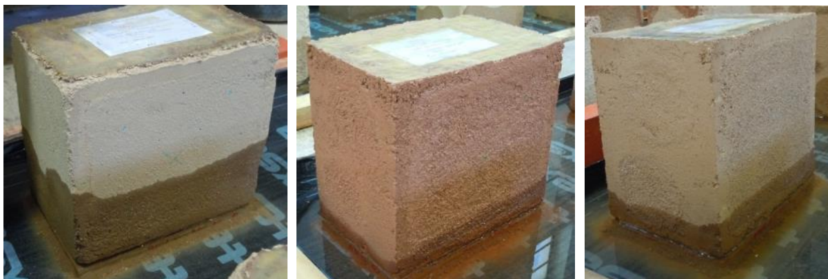
Figura 7.30. Método de absorção de água por ascensão capilar, ao fim de 12h em absorção capilar: à esquerda, BAv com argamassa AAv; ao centro, BPD com a argamassa APD; à direita, BVC com a argamassa AVC
