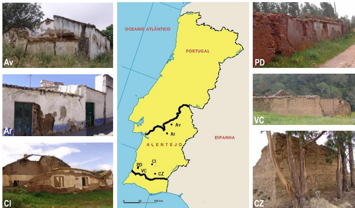
Figura 4.1. Localização geográfica dos seis edifícios em taipa não estabilizada no Alentejo, Portugal, onde foi efetuada a recolha de material para caracterização da matéria-prima
