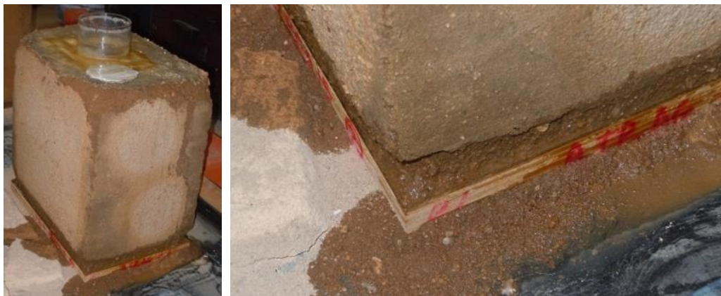
Figura 7.28. Finalização do ciclo de molhagem após o aparecimento de água pela base pelo método de absorção de água a partir do topo
