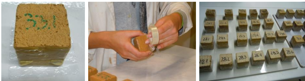
Figura 3.6. Sequência dos trabalhos no ensaio de secagem: à esquerda, provete saturado; ao centro, selagem do provete com folha de polietileno; à direita, provetes sujeitos ao ensaio de secagem
