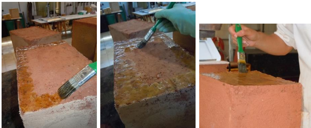
Figura 7.23. Impermeabilização da zona superior dos blocos
