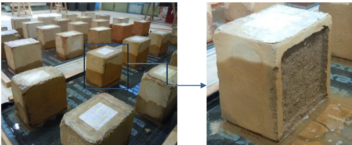
Figura 7.34. Bloco BAv com a aplicação da argamassa ATP_CN15: à esquerda, 12 h após o início da fase de absorção por ascensão capilar; à direita, 24 h após o início desta fase
