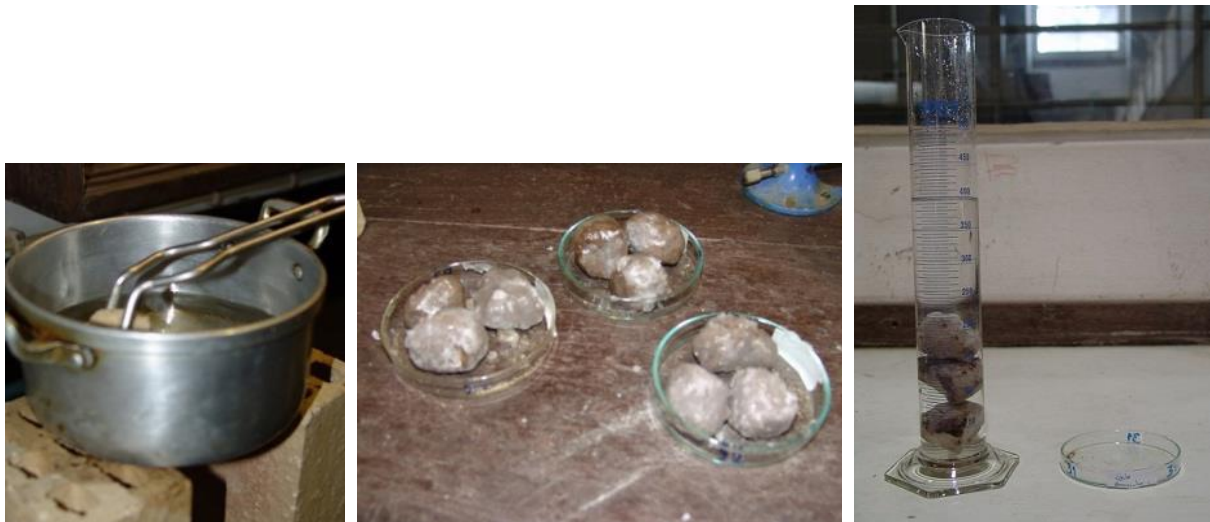
Figura 3.2. Metodologia de ensaio para determinação da baridade seca: à esquerda, provete mergulhado em parafina derretida; ao centro, caixas de petri de vidro, cada uma contendo material para um ensaio; à direita, provetes numa proveta graduada com água
