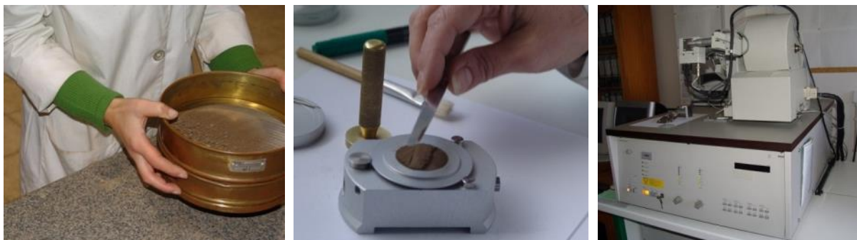
Figura 3.1. Sequência de trabalhos para a caracterização mineralógica efetuada por difratometria de raios X: à esquerda, peneiração da amostra; ao centro, introdução da amostra no porta amostras; à direita, equipamento utilizado X Philips X'PERT
