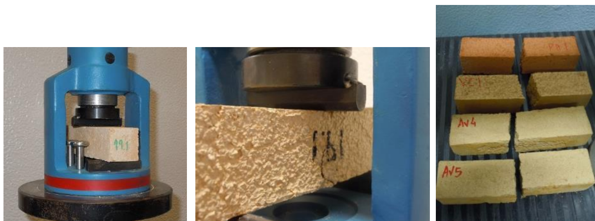
Figura 3.8. Sequência dos trabalhos no ensaio de resistência à tração por flexão: à esquerda, colocação do provete no equipamento; ao centro, provete sujeito ao ensaio; à direita, resultado final sobre os provetes
