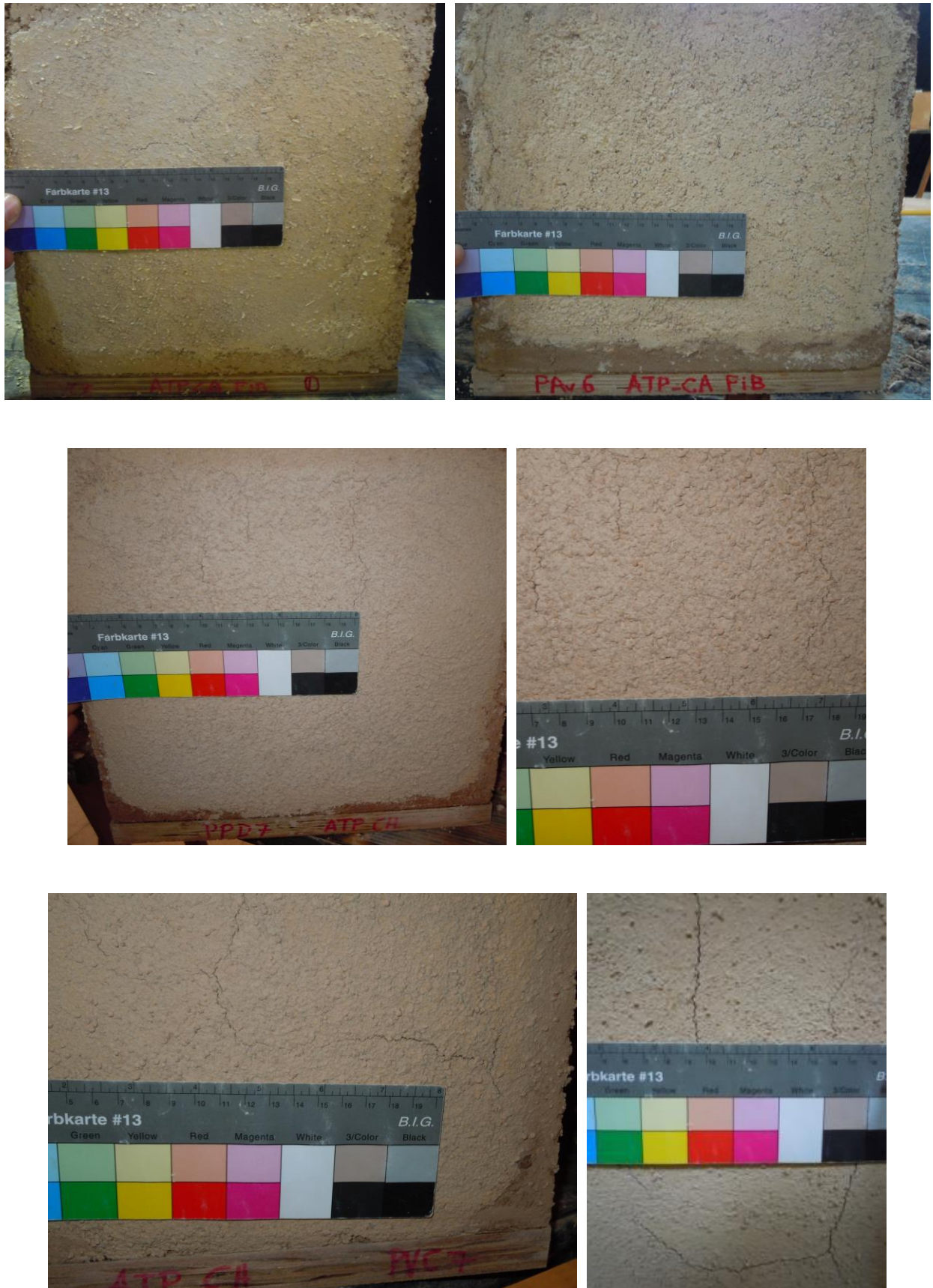
Figura 7.8. Densidade do padrão de fissuração na superfície da argamassa: em cima, nível 1, fraca intensidade, ATP_CA15_Fib no BVC; ao centro, média intensidade, ATP_CH15 no BPD; em baixo, alta intensidade, ATP_CH15 no BVC
