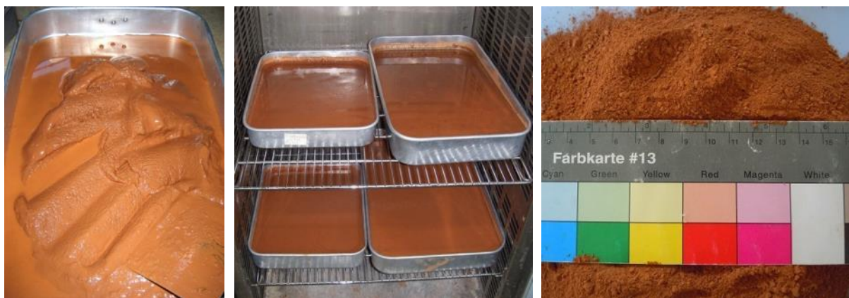
Figura 5.2. Preparação do material terra: à esquerda, após sujeito a decantação; ao centro, secagem do material em estufa ventilada; à direita produto final (MPD_A) após ter sido sujeito ao moído de maxilas
