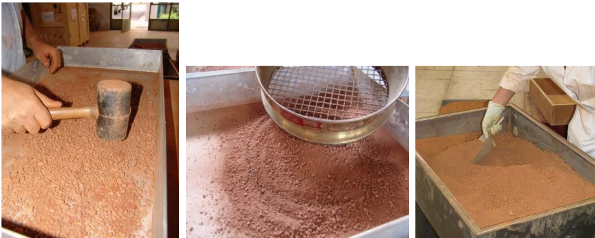
Figura 5.1. Preparação do material para realização dos blocos de taipa: à esquerda, desagregação dos torrões com o auxílio do martelo de borracha; ao centro, seleção da terra através de peneiração; à direita, matéria-prima final
