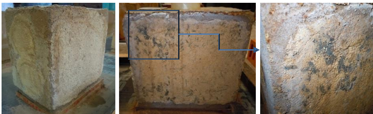
Figura 7.37. Bloco BAv com a aplicação da argamassa ATP_CA15_Fib pelo método de absorção de água a partir do topo: à esquerda, antes de iniciar o 1º ciclo com algum aparecimento de sais; ao centro, após a finalização do 8º ciclo com extensa visualização de bolores e fungos; à direita, pormenor da superfície do bloco
