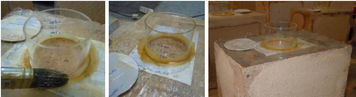
Figura 7.26. Colocação de um cilindro de vidro no topo do bloco, para a realização do método de absorção de água a partir do topo dos blocos
