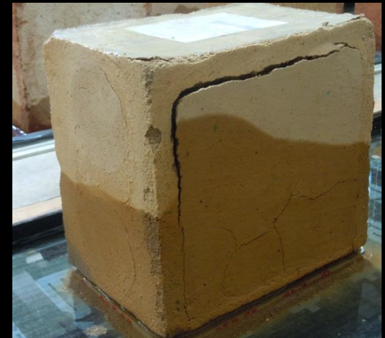
Av + mortier de terre-standard avec ciment naturel
