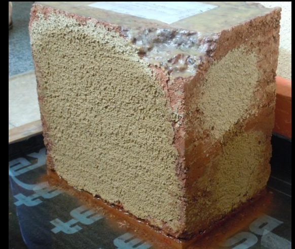
PD + mortier de terre-standard avec ciment Portland
