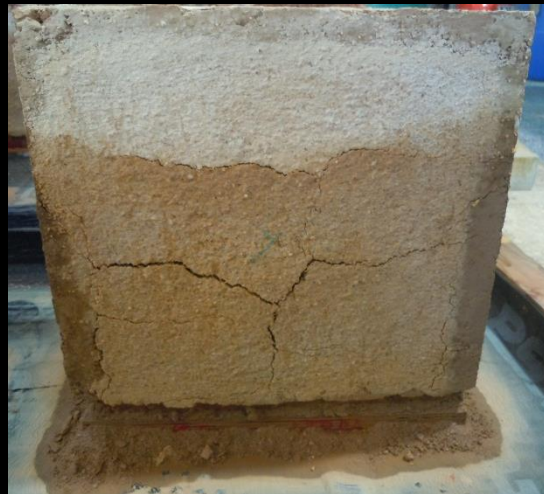
VC + mortier de terre-standard avec chaux aérienne
