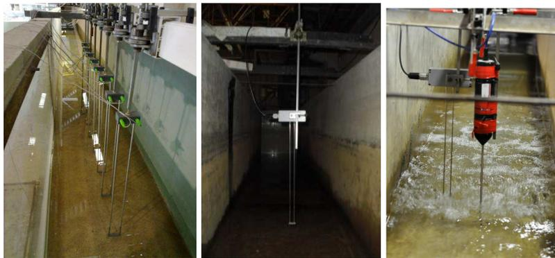
Figura 4. Conjunto de 8 sondas de nível (esquerda), sonda de nível junto ao batedor (centro) e sondas ADV e de nível (direita).
