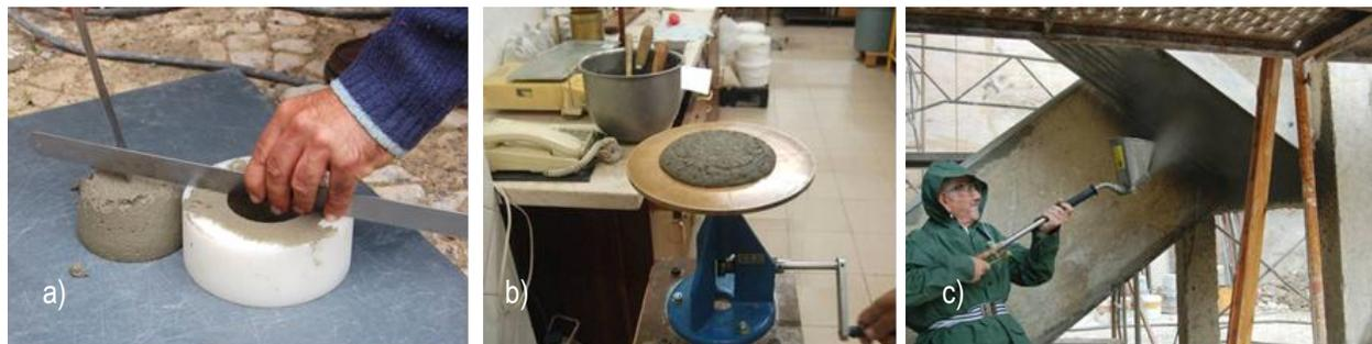
Fig. 4: Obra de reparação da escada exterior de serviço: consistência das PCMs medida em obra (método interno) (a) e em laboratório (ASTM C 1437) (b). Aplicação das PCMs por projeção (c)
