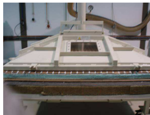
Fig. 15 – Ensaio de resistência à sucção do vento
