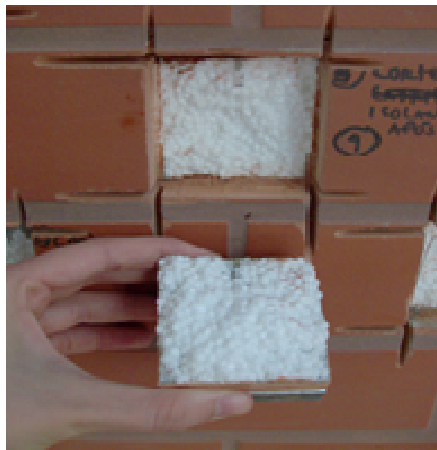
Fig. 12 – Recolha de carote após ensaio de aderência
