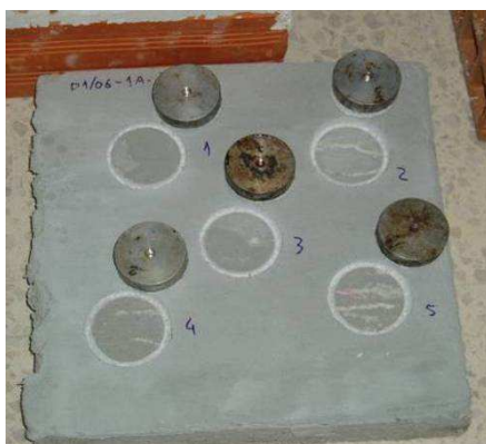
Fig. 14 – Ensaio de aderência do produto de colagem ao betão
