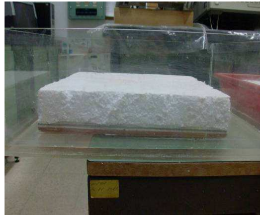
Fig. 13 – Ensaio de absorção por capilaridade
