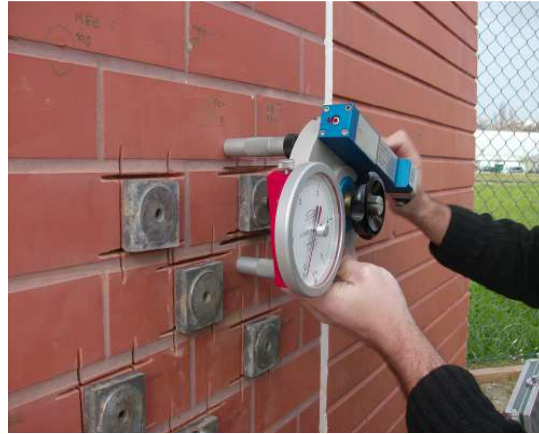
Fig. 11 – Ensaio de aderência
