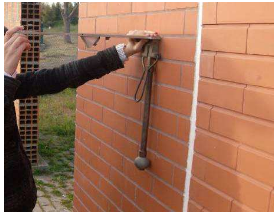
Fig. 9 – Ensaio de choque de 3 J
