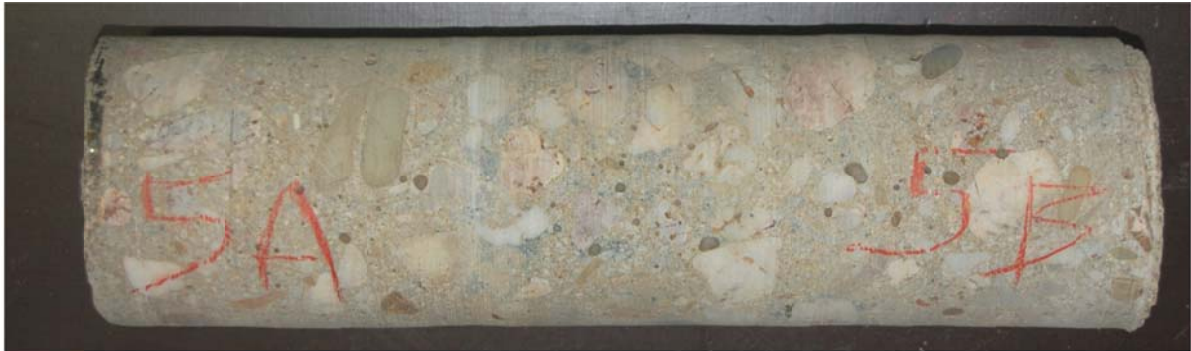
Carote 5: Viaduto 1; Pilar Parede N°3; ( \varnothing = 92 mm; comp. máx= 331 mm); Dimensão do agregado > 1/3 \varnothing
