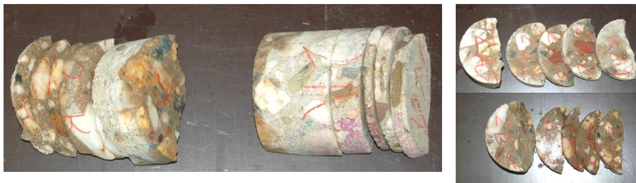
Figura 35: Provetes de ensaio obtidos da carote 2, da metade dos provetes dos topos, face oeste e face este
