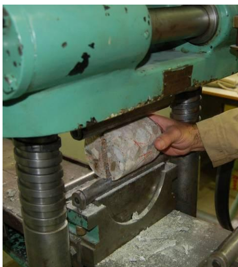
Figura 32: Obtenção da rotura da secção transversal dos provetes de ensaio
