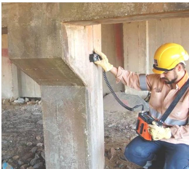
Figura 21: Medição in situ da espessura do recobrimento com um covermeter
