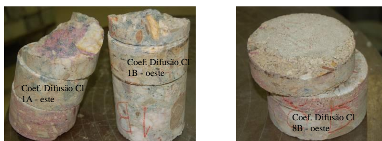
Figura 41: Provetes de ensaio usados para a determinação do coeficiente de difusão dos cloretos (L=50 mm; Ø ≈ 100 mm)
