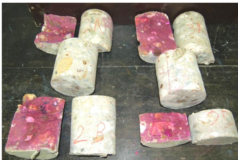
Figura 33: Aspecto da frente de carbonatação nas faces oeste (A) e este (B) dos pilares parede, a partir dos provetes de ensaio obtidos das carotes
