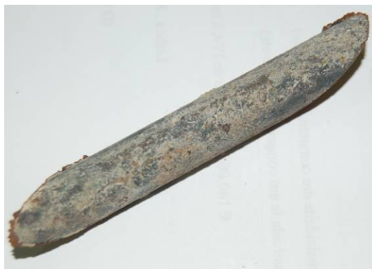
Figura 26: Aspecto liso da superfície do varão de aço
