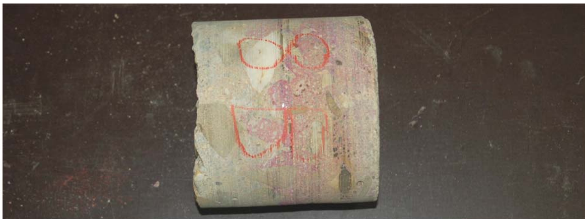
Carote 8: Viaduto 2; Pilar Parede N°7; ( \varnothing = 101 mm; comp. máx= 94 mm); Dimensão do agregado > 1/3 \varnothing
