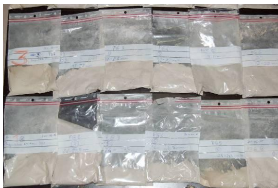
Figura 36: Sacos com as colheitas de pó seco do betão endurecido obtido por desgaste in situ
