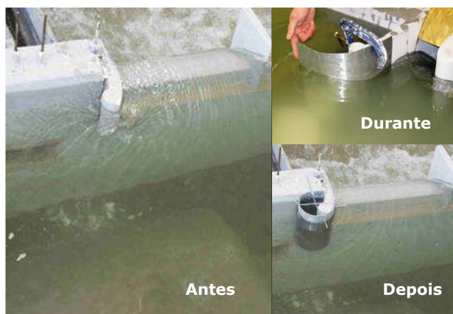
Figura 3: Modelo físico de um descarregador frontal. Abordagem empírica para definição de formas alternativas no caso dos muros-guia na entrada.
