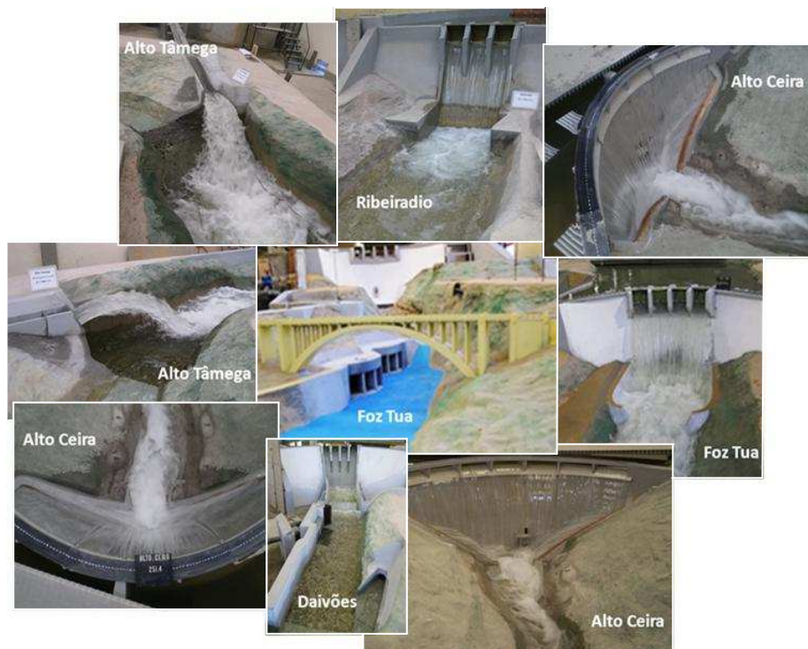
Figura 2: Modelos físicos reduzidos de descarregadores em fase de ensaio no LNEC.
