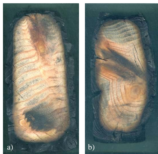
Fig. 7 – Alteração dos padrões de carbonização devido à presença de nós, nos elementos “perna” (a) e “linha” (b) da ligação 1.
