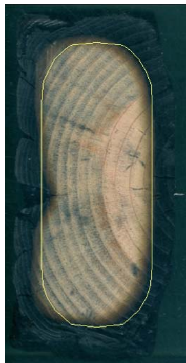
Fig. 14 – Comparação entre a secção residual experimental e a obtida com a análise numérica.
