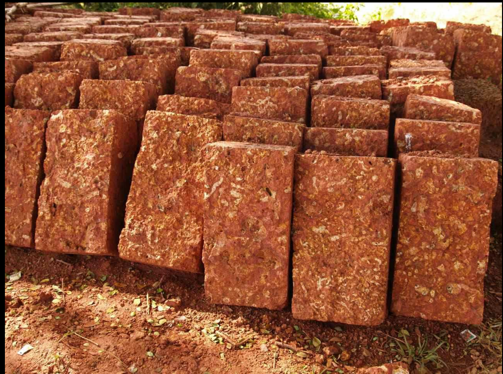
blocs de construction en latérite, Orissa, Inde (foto: Vitor Pacheco)
