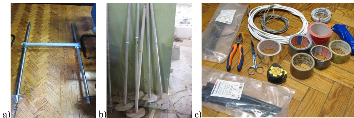
Figura 6: Acessórios de montagem. a) Estrutura H, b) Hastes com trado, c) Vários acessórios de montagem.
