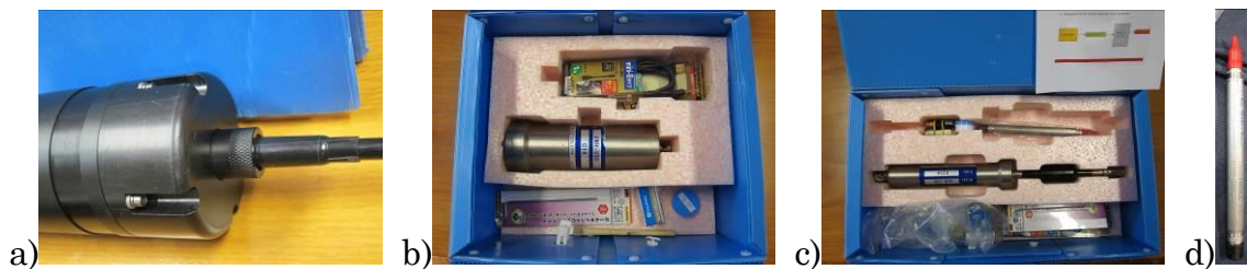
Figura 5: Equipamentos usados na campanha (da esquerda para a direita): a) ADCP, b) PT2, c) ECM2 e d) PT3.
