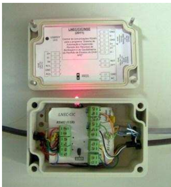
Fig. 6 Caixa que alberga o nó de comutação de protocolo.
