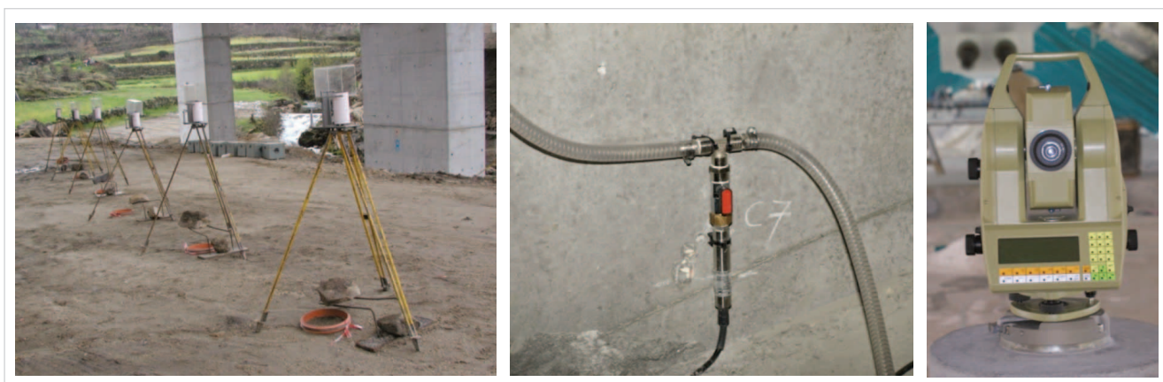
> Figura 7: Ensaios de carga do Viaduto da rua Ramalho Ortigão, em Lisboa, antes e após a sua reabilitação.
