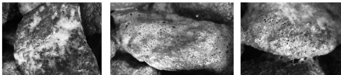
Figura 15 - Fenómenos de Efervescência Verificados nas Amostras de SAP em Campo.
