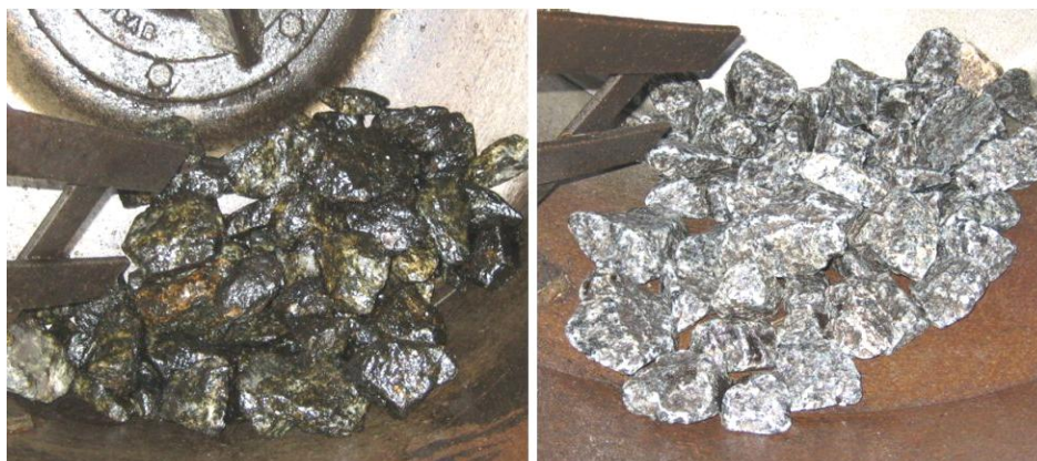
Figura 10 - Comparação Entre o Balastro Antes e Depois do Processo de Lavagem com SOLV-LAT a 10%.
