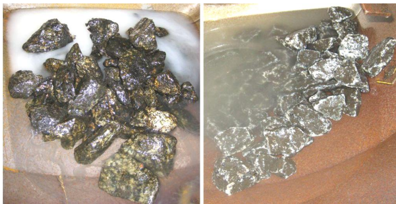
Figura 9 - Comparação Entre o Balastro Antes e Depois do Processo de Lavagem com LAT-SOLV.2 a 10%.
