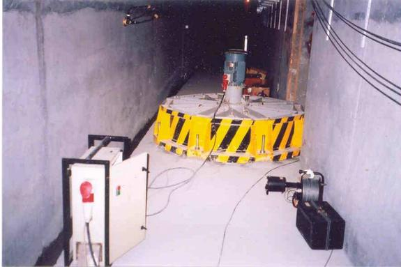
Fig. 1 – Vista do vibrador de massa excêntrica
