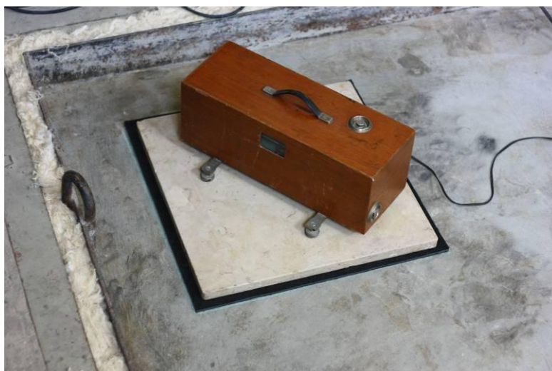
Figura 1 – Ilustração de um dos sistemas de piso flutuante; neste caso, com o material tipo B.
