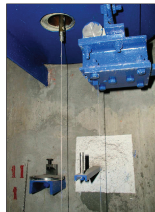
Figura 1 – Método do fio-de-prumo direito e invertido (respectivamente à direita e à esquerda na Figura).
