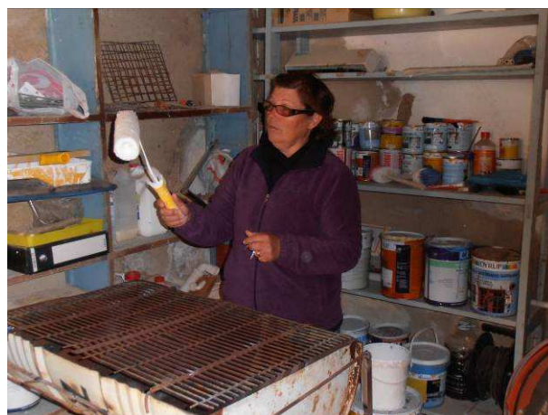
Fig. 15 – Rolos utilizados atualmente quando se procede a pinturas com tinta sintética
