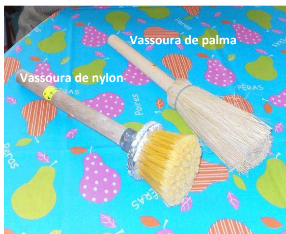
Fig. 13 – Utensílios utilizados na caiação (antigamente e atualmente)
