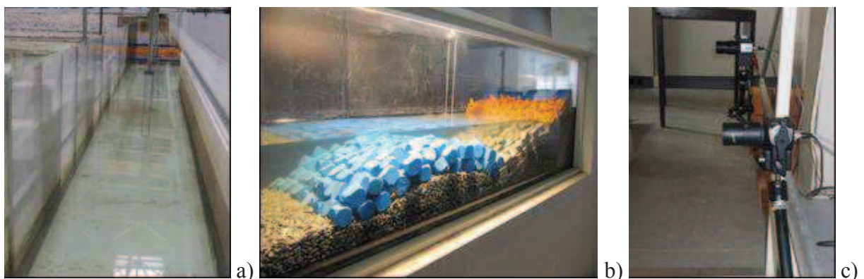
Figura 2 - Configuração do modelo físico: a) canal construído dentro do tanque b) pormenor do modelo reduzido c) câmaras de captura de imagem.
