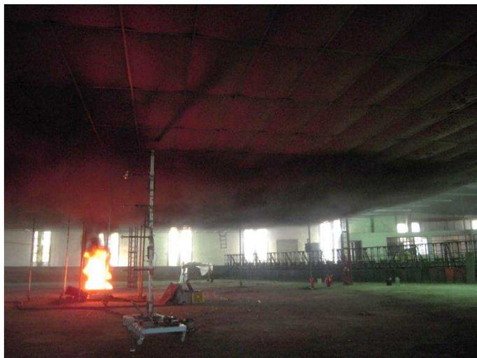
Fig. 5. Bloqueio do escoamento devido à ação dos ventiladores de impulso
