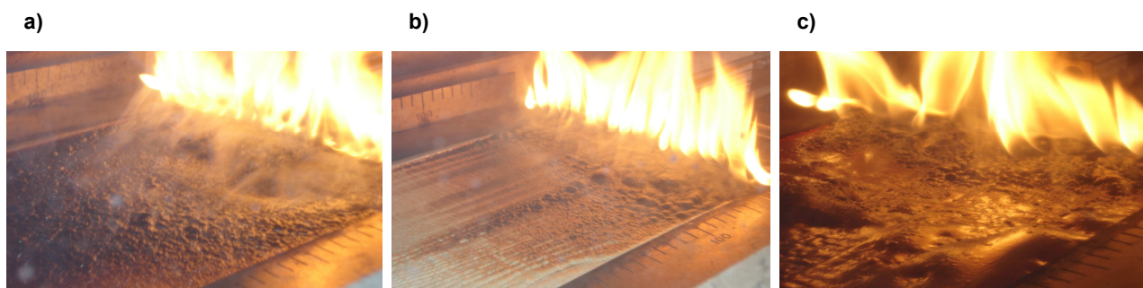
Figura IV. 23 Processo intumescente nos provetes: a) SLP3, b) SLP4 e c) CIP5
