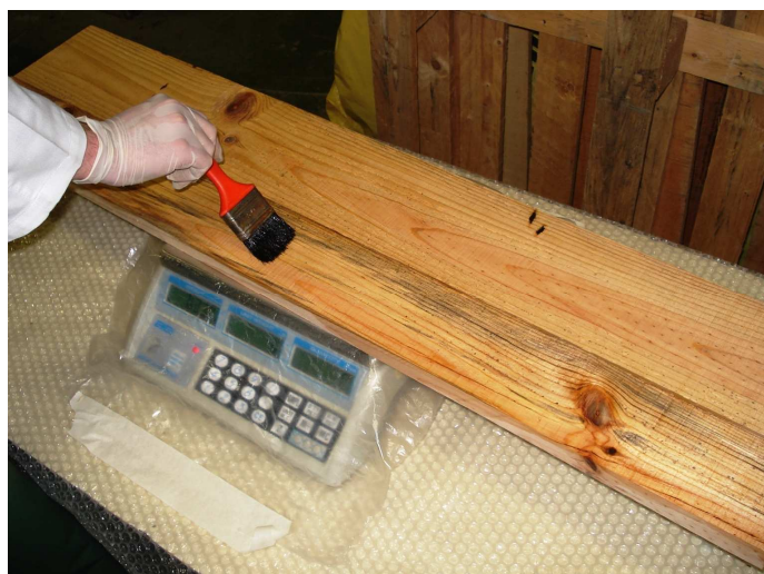
Figura IV. 1 Aplicação do insecticida no provete CIPx, na sala de ensaios do NEM
