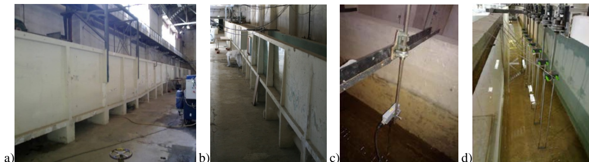
Fig. 1 – a) e b) Vistas do canal de ondas utilizado para os ensaios experimentais; c) Sonda junto ao bateror; d) Conjunto de 8 sondas.
