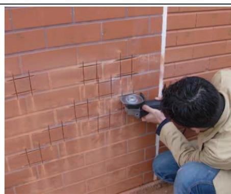
Fig. 2 – Execução das incisões num ETICS com acabamento cerâmico
