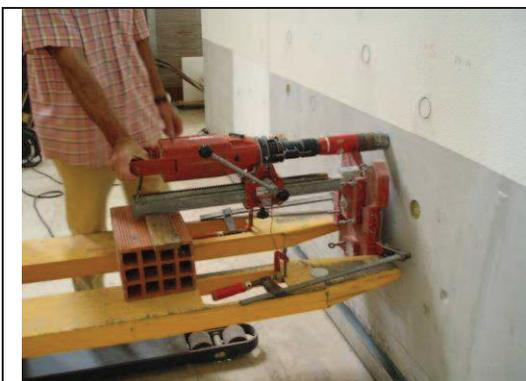
Fig. 1 – Execução das incisões num ETICS com acabamento por pintura
