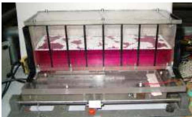
Figura 35 – Amortecedor de líquido sintonizado com a água corada com permanganato de potássio, adaptado de [Chalmers e Bayley, 2007]
