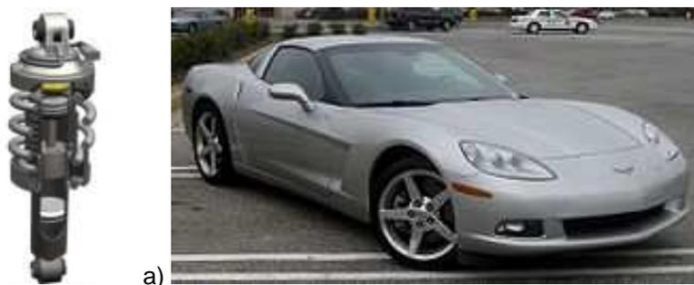
Figura 163 - Implementação de amortecedor de fluido controlável Magneo-reológico na indústria automóvel: a) Detalhe do dispositivo colocado [IMAGES GOOGLE, 2009] e b) Chevrolet Corvette [IMAGES GOOGLE, 2009]
