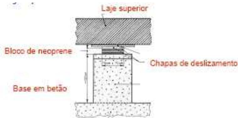
Figura 5 - Detalhe do sistema de isolamento usado na Central nuclear de Kroeberg, Africa do Sul [Guerreiro, 2003]
