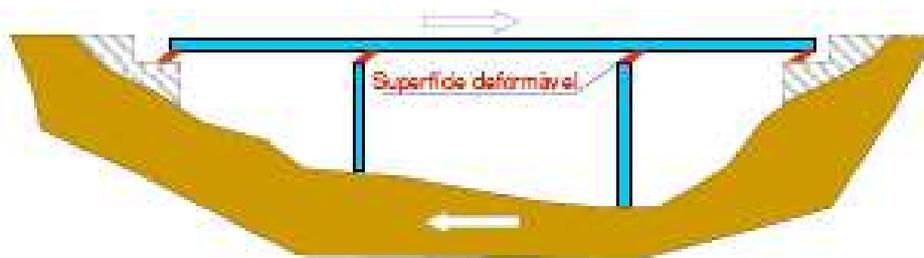
Figura 13 - Colocação do isolamento de base em pontes [Guerreiro, 2006]
