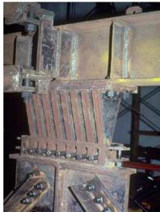
Figura 37 - Processo de deformação de um dispositivo TADAS sob a simulação de uma dada acção sísmica [Aiken, 2006].
