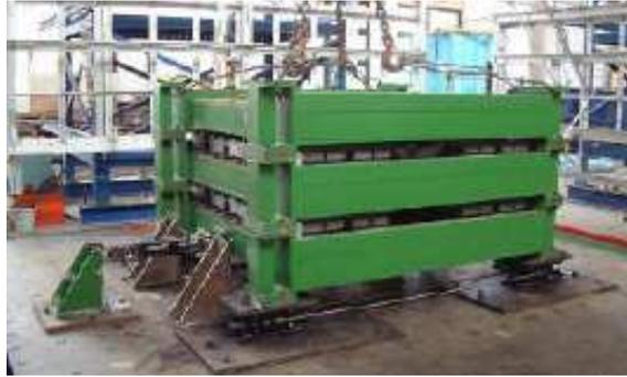
Figura 153 – Sistema híbrido de isolamento de base constituído por um conjunto de pêndulo (passivo) e amortecedor magnetoreológico (semi-activo) – Dispositivo de ensaio
