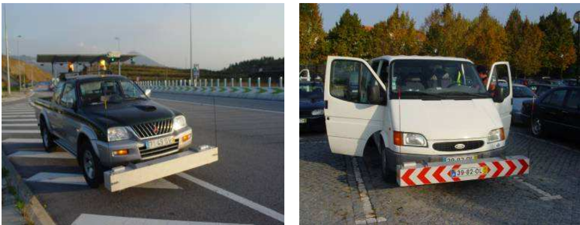
Figura 1 | Perfilómetros laser utilizados na caracterização superficial dos pavimentos
