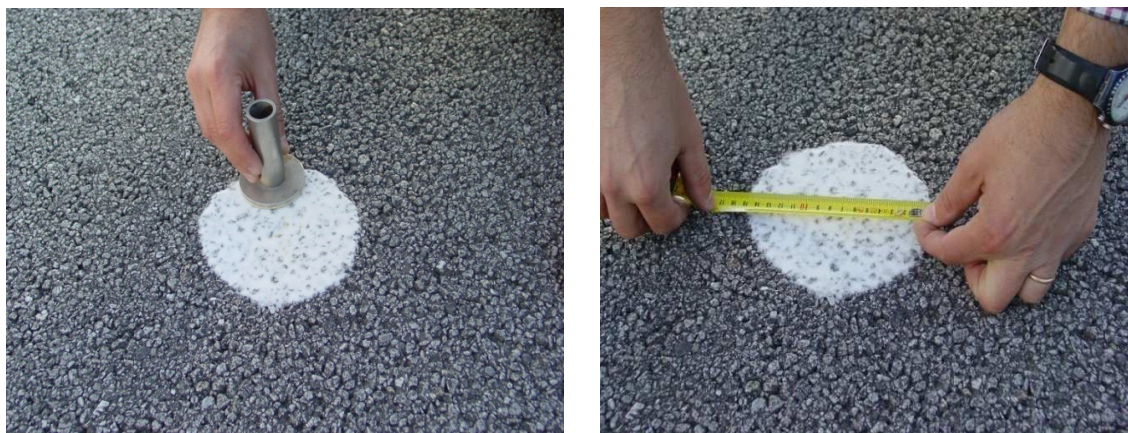
Figura 2 | Medição da profundidade de textura pelo método da mancha
