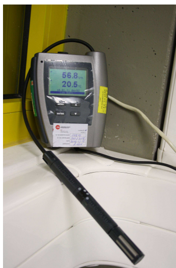
Figura A1.12 – Termohigrómetro de monitorização ambiental colocado numa das salas laboratoriais
