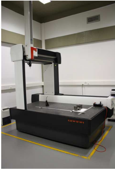
Figura A1.16 – Marcação do maciço anti-vibratório (sala de calibração dimensional 3 - máquina de medição de coordenadas 3D).
