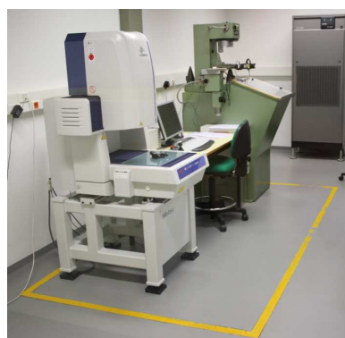
Figura A1.15 – Marcação do maciço anti-vibratório (sala de calibração dimensional 2)
