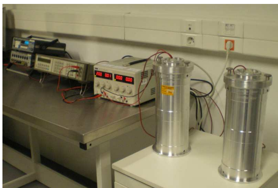
Figura 4 – Montagem para a calibração de calorímetros de Langavant (DM)
