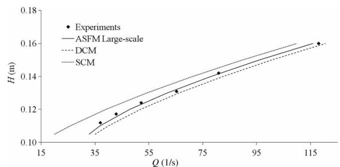
Figure D2 Stage-discharge curve: (—), large-scale Eq. (6); (---), DCM; (···), SCM
