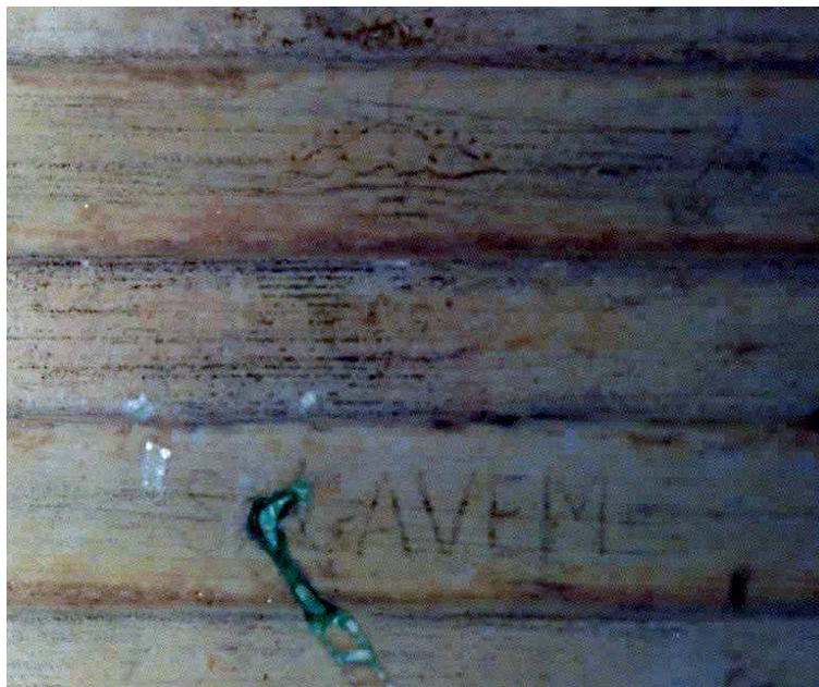
Figura 7- Pormenor de um tardoiz típico de um azulejo em pó de pedra marcado “SACAVÉM” e com a coroa indicativa da “Real Fábrica” (primeira década do século XX).
