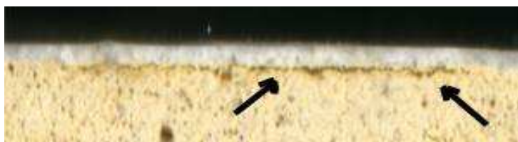
Figura 27- Secção num azulejo descascado, mostrando a separação local entre o vidrado (branco) e a chacota
