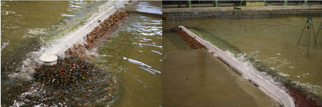
Fig. 16 – Aspecto de um ensaio de estabilidade e galgamentos do quebra-mar associado à expansão do Porto de Sal-Rei
