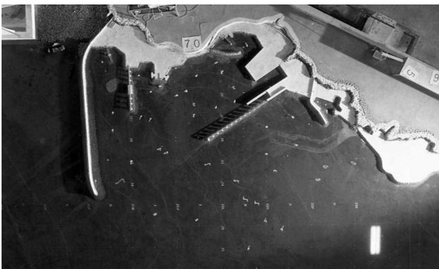
**Fig. 7 – Estudo em modelo reduzido da agitação no interior do Porto de Sines**
