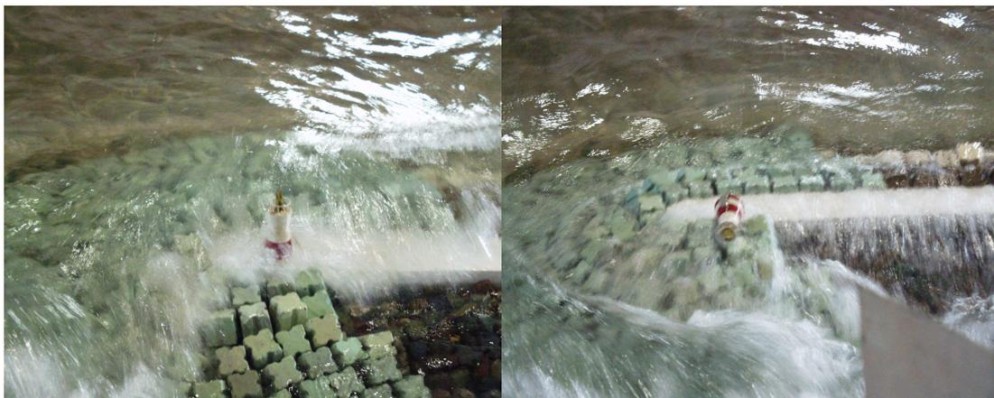
Fig. 15 – Aspecto de um ensaio de estabilidade e galgamentos do prolongamento do molhe Norte da entrada do Porto da Figueira da Foz
