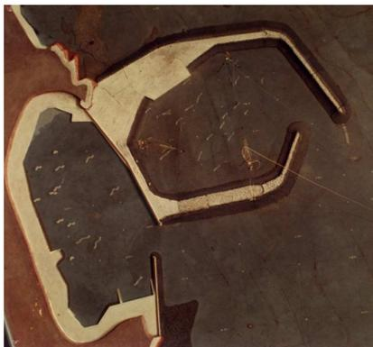
**Fig. 10 – Modelo reduzido destinado ao estudo das condições de agitação e de ressonância no interior do Porto de S. Quay-Portrieux**
