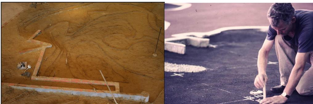
Fig. 17 – Aspecto da construção dos modelos. Construção dos fundos (à esquerda) e marcação do modelo (à direita)
