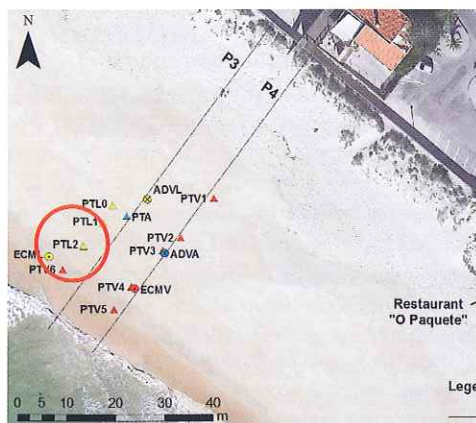
Figura 2 – Localização da instrumentação utilizada ao longo de dois perfis na praia de Faro. No interior do círculo vermelho, mostram-se os sensores PTL1 e PTL2.
