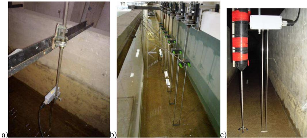
Figura 3 – Equipamento de medição: a) Sonda junto ao baterdor; b) Conjunto de 8 sondas; c) ADV e sonda resistiva.
